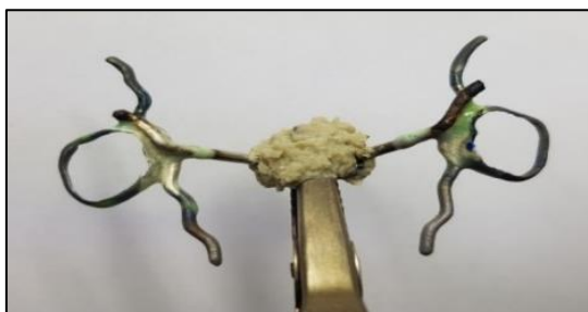
11 pav. Sidabro lydmetaliu galutinai sutvirtinta konstrukcija
