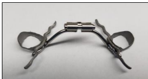
10 pav. Taškiniu lazeriu sutvirtinta konstrukcija
